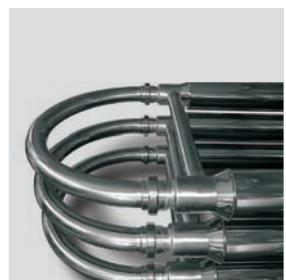
Gli scambiatori tubolari sono formati da due tubi concentrici dove lo scambio termico avviene in controcorrente tra il prodotto (che percorre il tubo interno) e il fluido refrigerante (che percorre l'intercapedine tra tubo interno e tubo esterno). Consentono un rapido abbassamento della temperatura del prodotto e sono particolarmente indicati per la lavorazione di sostanze fluide (mosto, vino...) e di sostanze dense o viscose (diraspato, creme...).
